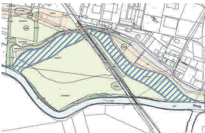
Gigantisches Vorhaben: Die geplante Flutmulde (blau gestrichelt) verläuft nördlich der Kinzig (hellblau) vom Galgenfeld (links) bis zur Freigerichter Straße.
